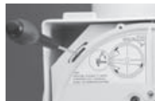
Démontage de la plaque-moteur
