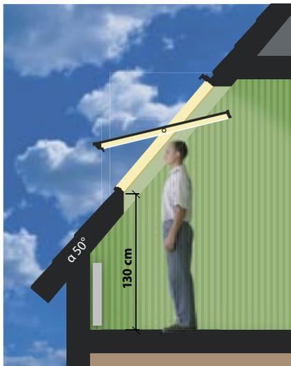
Les fenêtres pivotantes adoptant le système le plus connu dans la conception des fenêtres de toit. Elles permettent d'éclairer et d'aérer une pièce. Elles s'ouvrent par rotation sur un axe central jusqu'à 180° pour faciliter le nettoyage de la vitre extérieure et le maniement du pare-soleil extérieur. De nombreux accessoires pour l'intérieur et l'extérieur sont disponibles.
