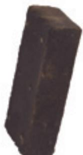
La **brique pressée** est la brique obtenue en pressant mécaniquement la pâte argileuse dans les moules; on obtient une brique nette et de forme angulaire.
