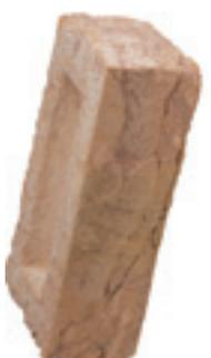
La **brique faite à la main** est la brique obtenue en introduisant une quantité d'argile préalablement sablée dans un moule; on obtient ainsi un aspect typiquement nervuré.
