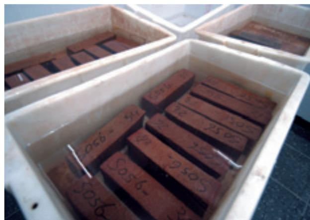
L'absorption d'eau d'une brique peut être un facteur important pour les briques qui sont maçonnées, non pas verticalement, mais horizontalement ou de biais (ex: plinthes) et qui sont donc plus exposées à la pluie. Cette valeur donne une indication quant à la sensibilité à la formation de mousse.
