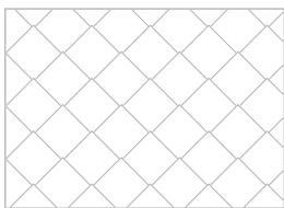
Pose en losange
